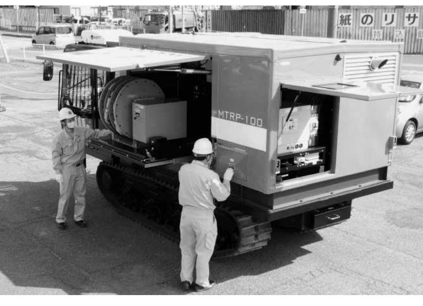
開発した移動電源車には電気を供給するためのケーブル類も内蔵した
