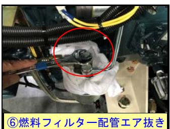
⑥ 燃料フィルター配管エア抜き
